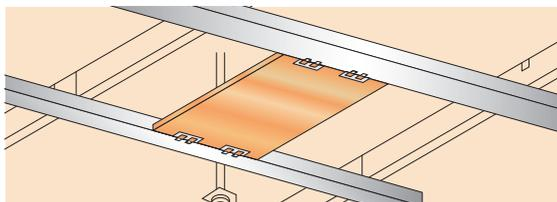
02 下地板をスライドして取り付け、完成(下地板へのビス留めは行わなくてOK)
